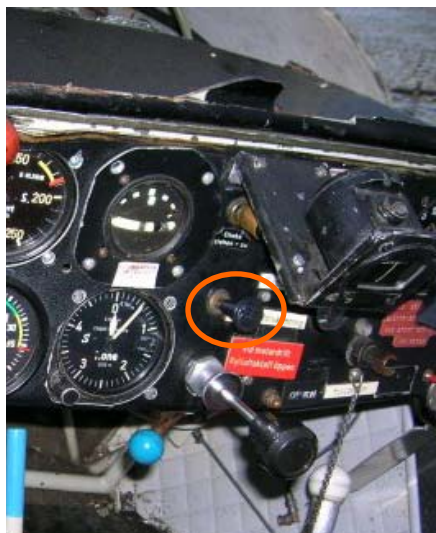
Bild 4 tagen på haveriplatsen där man ser reglaget för förgasarvärmen är i stängt läge.
