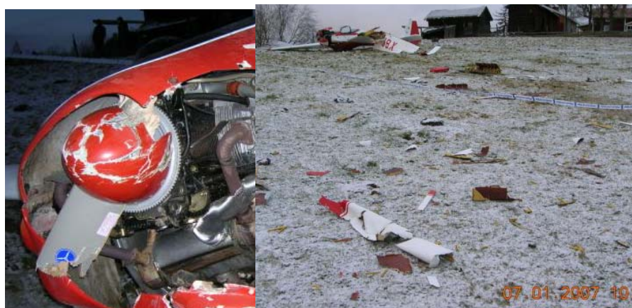
Bild 2, 3 tagna på haveriplatsen bild1 föreställer den sönderslagna propellern och på bild 2 kan man se det utdragna bandet med spillror från flygplanet. Häribland så är spillror från propellern utspridda över ett stort område.
